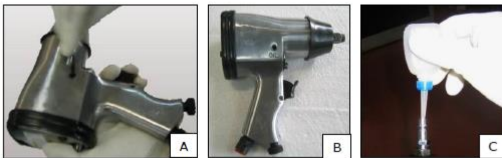
Фигура 7 – Смазване на инструмента
